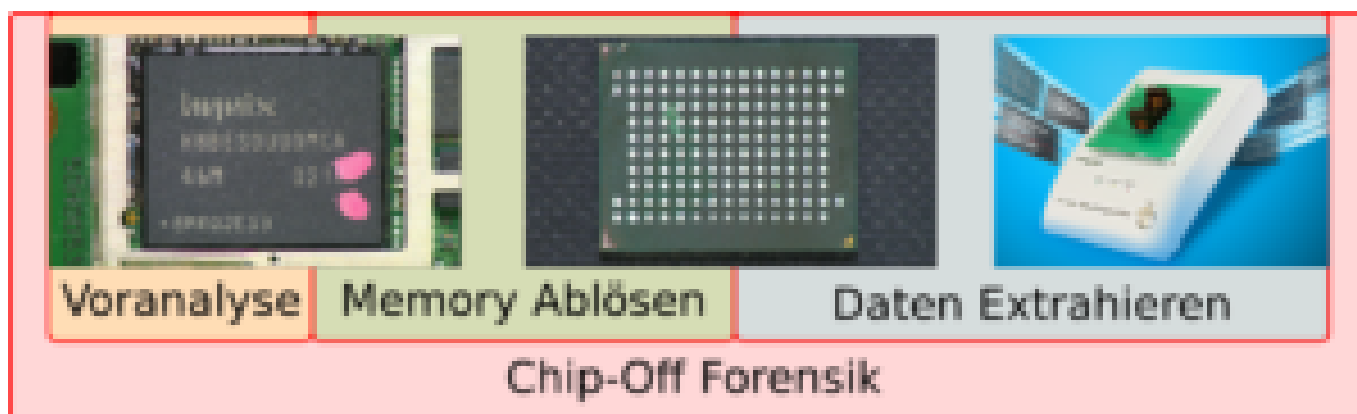
Abb. 3: Die drei Phasen eines Chip-Off-Prozesses [4]
